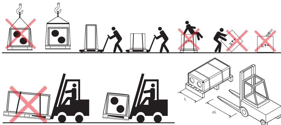
Rys. 4. Przykłady transportu dźwigiem, wózkiem widłowym lub paletowym.
